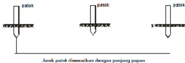
Gambar 3.4: Pemasangan Patok – Patok Papan Acuan Konstruksi
