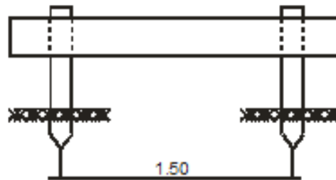
Gambar 3.5: Pemasangan Papan Acuan
