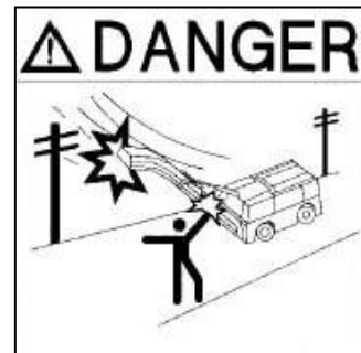
Gambar 3.3 – Perhatikan kabel listrik dan telpon
