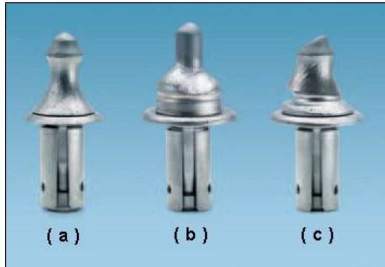
Gambar 2.17 – Keausan cutting tools yang tidak optimal
