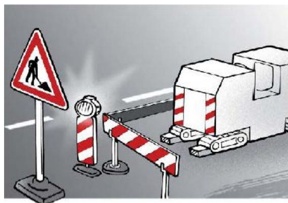
Gambar 5.3. Rambu dilarang memasuki area kerja
