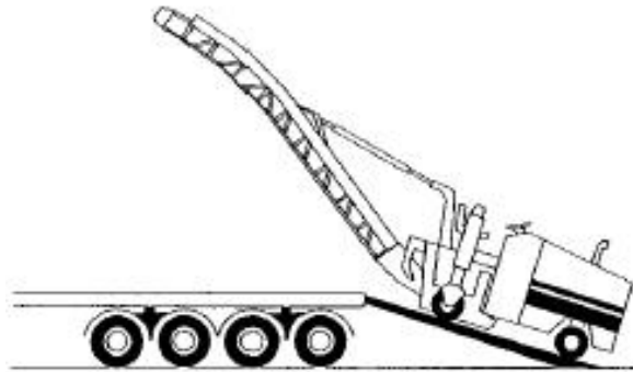
Gambar 5.4 Pengangkatan Cold Milling Machine menggunakan Plat Oprit
