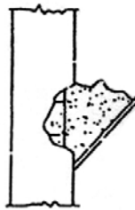
Gambar 4.11. Perbaikan Kolom Keropos
