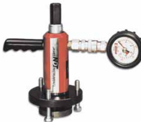
Gambar 4.5. Alat Pengukur Kekuatan Angkur
