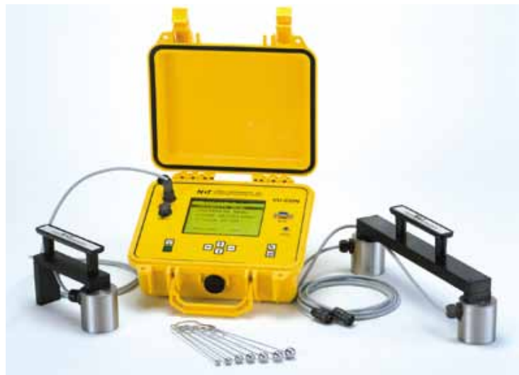
Gambar 4.2. Alat Pengukur Ketebalan dan Mutu Beton
