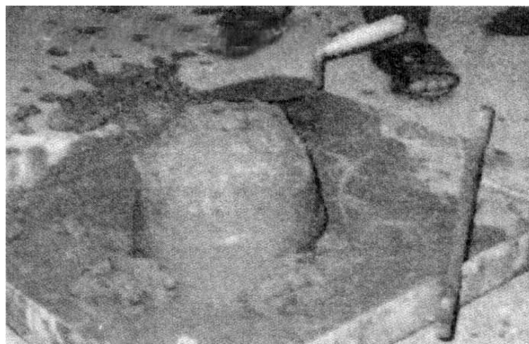
Gambar 2.4. Contoh slump terlalu tinggi (encer)
