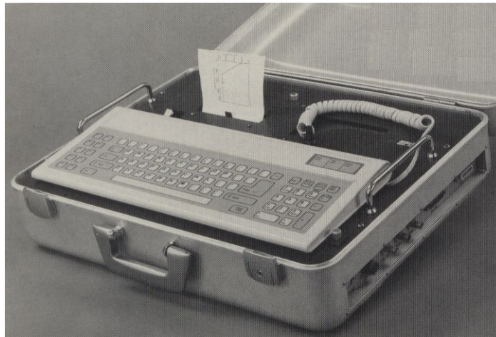
Gb. 3.2. Alat perekam kecepatan detonasi ( EG&G Special Projects )
