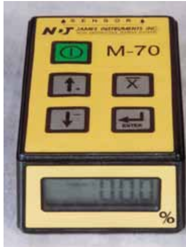
Gambar 2.6 Untuk Mengukur Kandungan Air Dalam Beton, Bata, Gypsum, Dan Benda Padat Lainnya.
