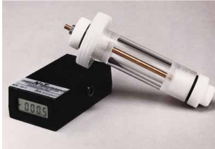
Gambar 2.11 Alat Untuk Mengidentifikasi Kemungkinan Korosi Pada Tulangan Dalam Beton
