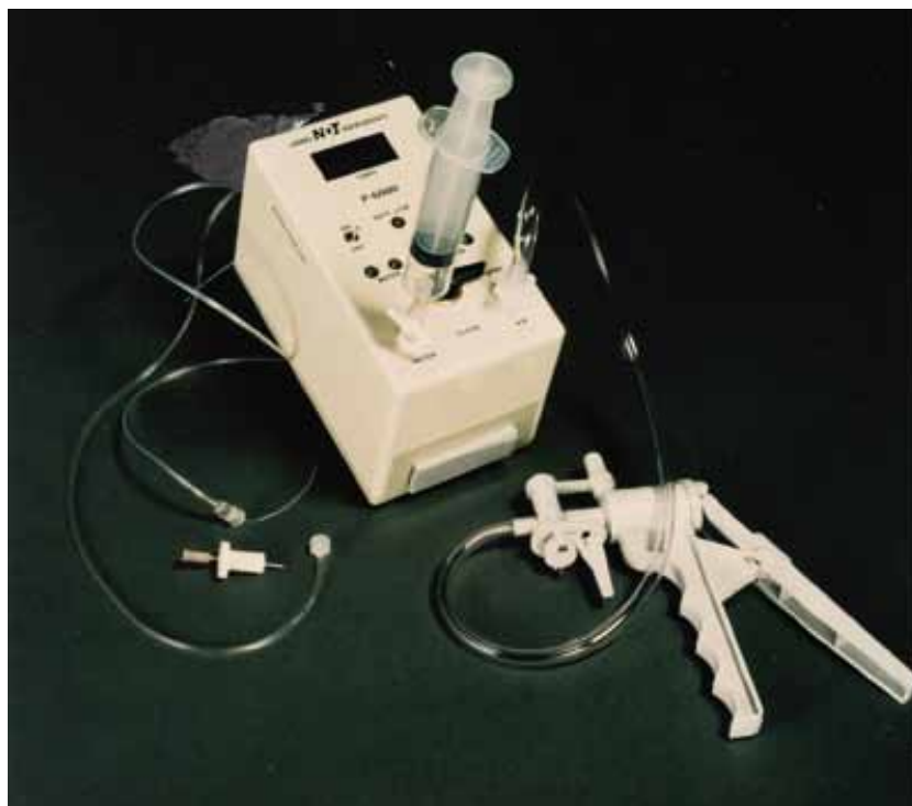
Gambar 2.22 Alat Untuk Mengukur Udara Dan Daya Serap Air Dalam Beton Pada Permukaan Bagian Atas Dan Bawah Beton
