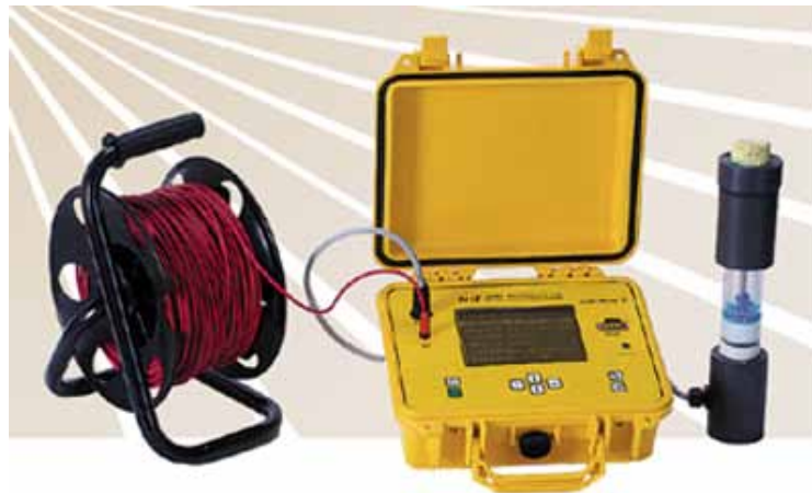
Gambar 2.12 Alat Untuk Mengidentifikasi Kemungkinan Korosi Pada Tulangan Dalam Beton Di Lapangan
