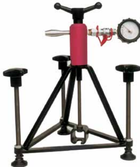
Gambar 2.5 Alat Untuk Mengukur Kekutan Angkur Dalam Beton
