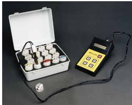
Gambar 2.9 Alat Untuk mengukur kandungan klorida dalam beton yang kering / basah
