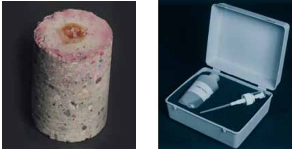
Gambar 2.8 Alat Untuk Mengukur Kandungan Karbon Dalam Beton Dengan Menggunakan Zat Pewarna
