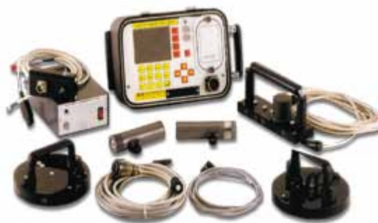
Gambar 2.16 Alat Untuk Mengukur Tingkat Dan Memetakan Korosi Pada Tulangan Beton
