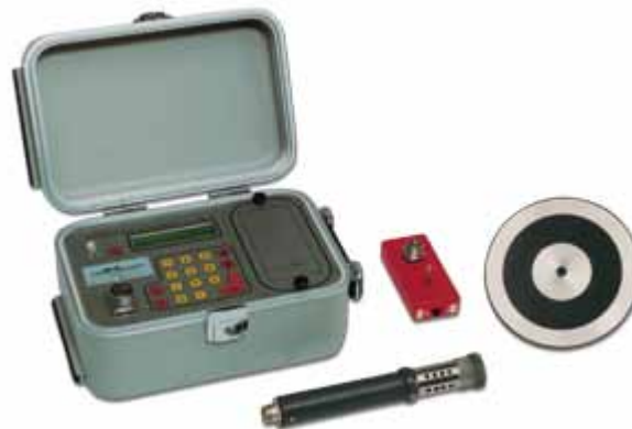
Gambar 2.15 Alat Untuk Mengukur Tingkat Korosi Pada Tulangan Beton Dan Kadar Lemas Dalam Beton
