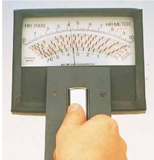
Gambar 2.17 Alat Untuk Mencari Lokasi Tulangan, Kedalaman Dari Permukaan Beton Dan Ukuran Tulangan
