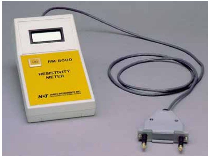
Gambar 2.21 Alat Untuk Mengukur Tingkat Korosi Tulangan Dengan Getaran Suara
