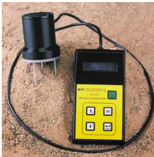
Gambar 2.25 Alat Untuk Mengukur Kelembaban Pasir Dan Bahan Lainnya
