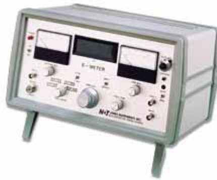
Gambar 2.14 Alat Untuk Menggunakan Resonansi Suara Untuk Mengukur Modulus Elastisitas, Modulus Geser, Rasio Poison, Dan Konstanta 'Damping'
