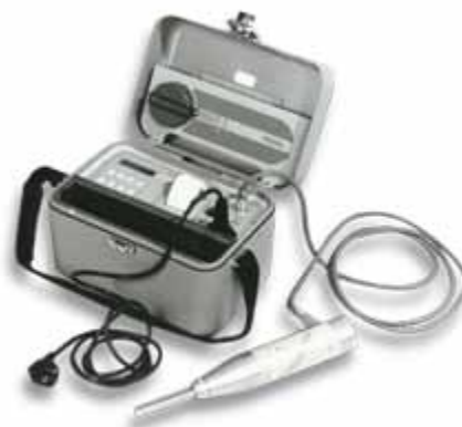
Gambar 2.10 Alat 'Hammer Test' Untuk Mengukur Kekuatan Tekan Beton Atau Kekerasan Beton
