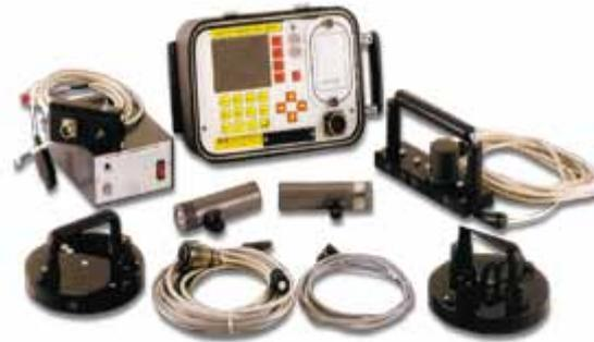
**Gambar 2.7. Alat Pendeteksi Korosi Tulangan Beton**
