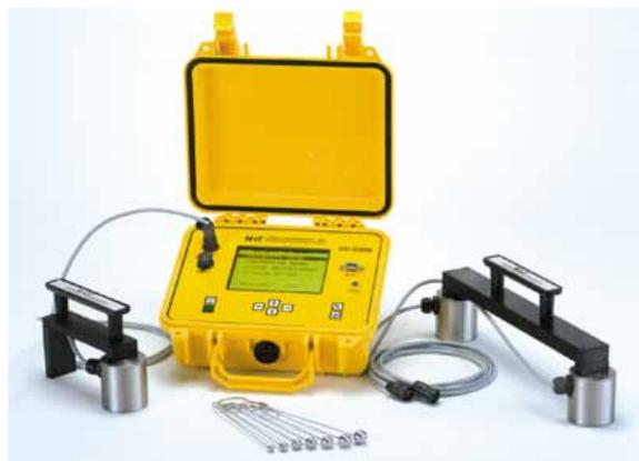
**Gambar 2. 10. Alat pengukur ketebalan dan mutu beton**
