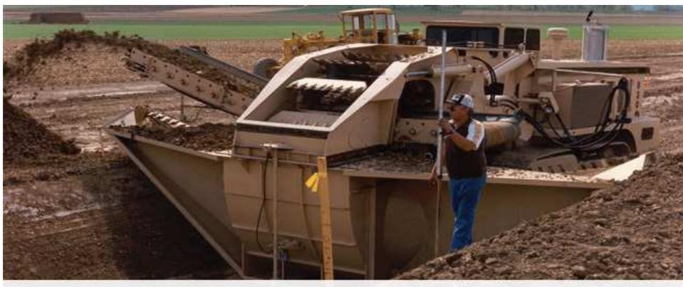
**Gambar 4.3.2 b)** Contoh peralatan untuk membuat saluran di luar negeri (*Trapezoidal Trencher*)
