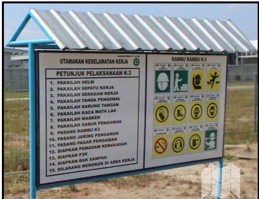
Gambar 18. Contoh rambu-rambu Keselamatan di lokasi kerja
