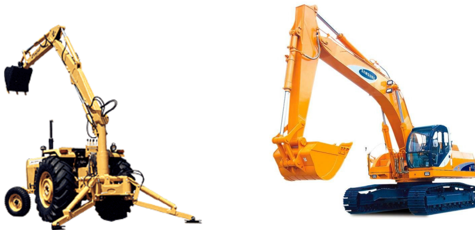
Gambar 6 : Wheel Excavator Dan Crawler Excavator (Jenis alat penggali tanah mekanis)
