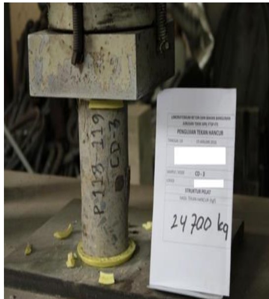
Gambar 3 : Hasil test silinder beton.
