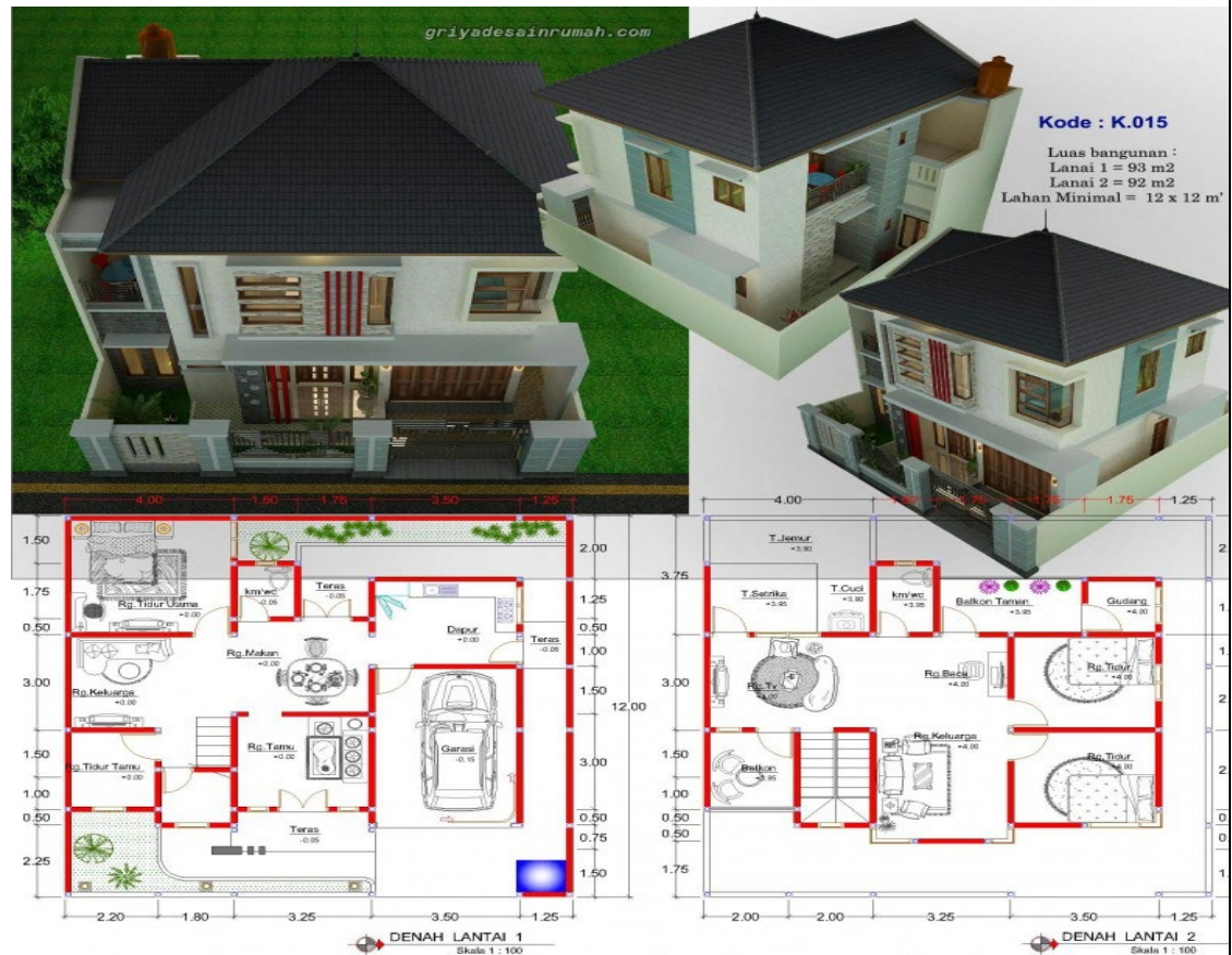
Gambar: 2. 6 As Built Drawing, gambar rekaman akhir yang dibuat sesuai terbangun dilapangan, yang telah mengadopsi semua perubahan selama pekerjaan Proyek Pembangunan Gedung.
