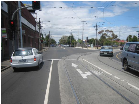
Gambar 7.9 Perbaikan Persimpangan Y dengan APILL.
