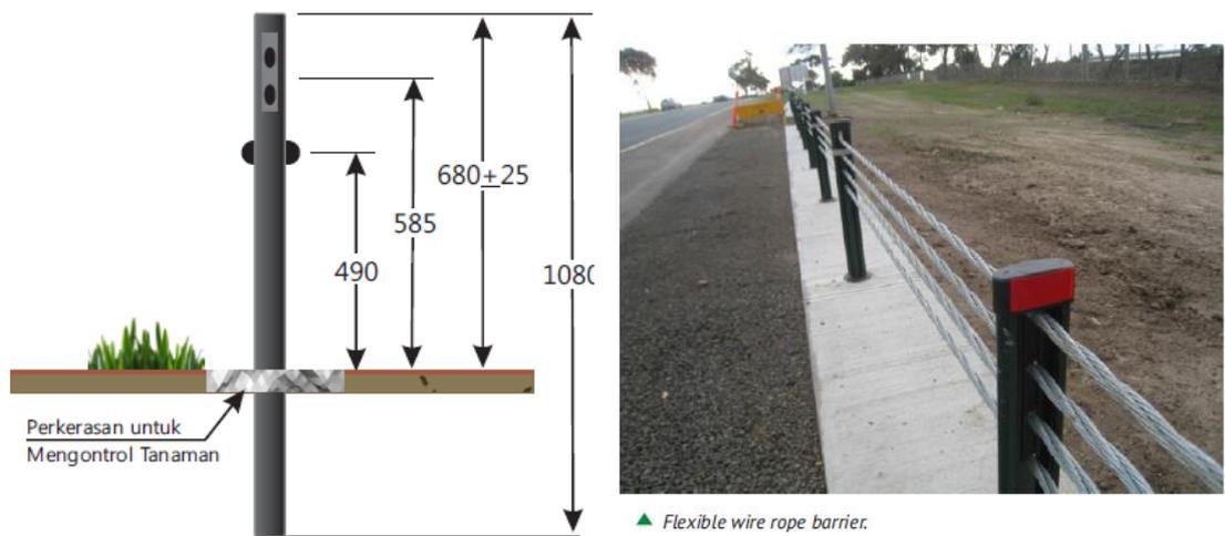
**Gambar 5.23** Contoh dari wire rope yang menggunakan empat tali yang saling mengait
