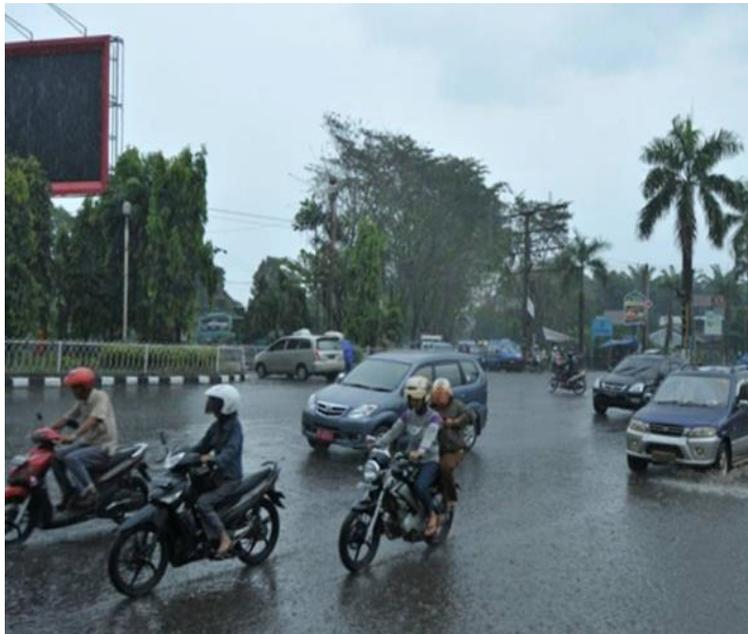
**Gambar 5.10** Saat air tidak langsung mengalir ke luar dari jalan dan menggenang di atas perkerasan, ada risiko mengapung. Ini berbahaya terutama bagi sepeda motor.
