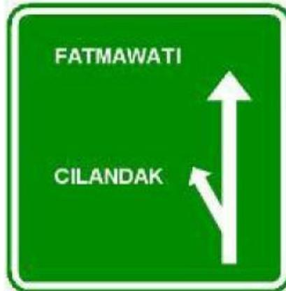
Gambar 3.103. Rambu diagramatik untuk simpang susun
