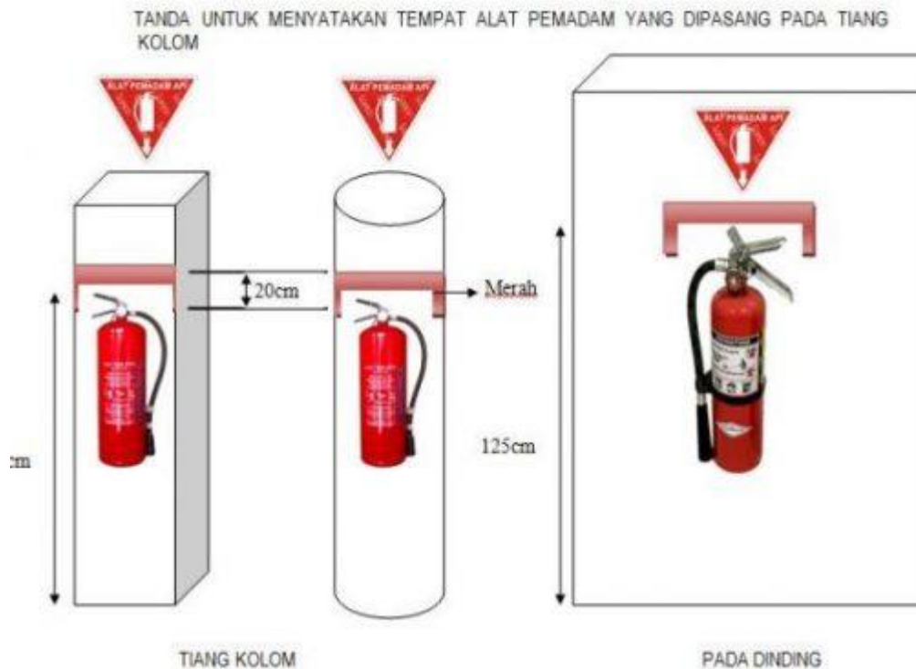
Gambar 4.2 Pemasangan Apar di Gantung pada Tiang atau Pilar
