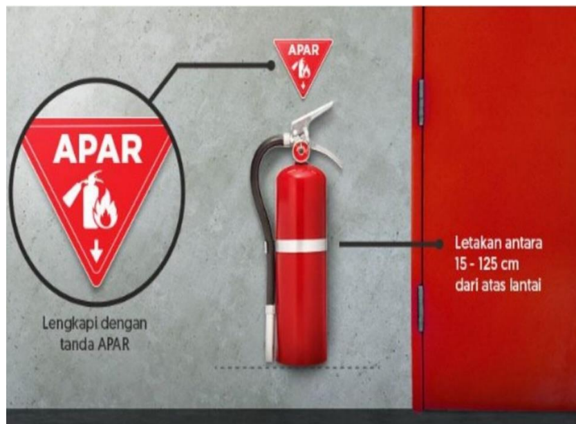
Gambar 4.1 Pemasangan Apar di Gantung pada Dinding Bangunan
