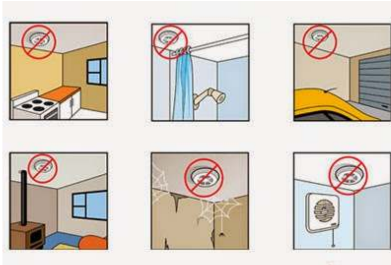
Gambar 2.3.Lokasi yang tidak diperkenankan memasang smoke detektor
