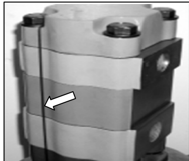
Gambar 4.24 Tanda pada bodi pompa
