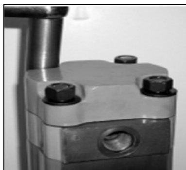
Gambar 4.25 Melepas mur pengikat
