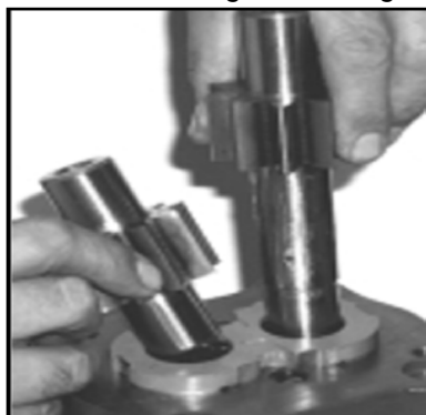
Gambar 4.29 Melepas drive dan idler gear
