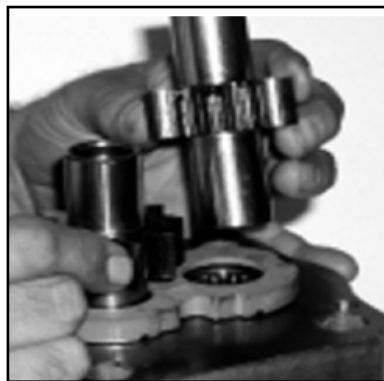
Gambar 4.33. Melepas drive dan idler gear
