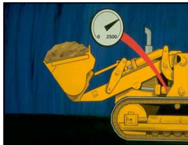
Gambar 4.16 tekanan pada silinder hidrolik
