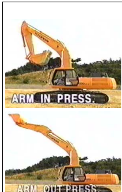
Gambar 4.31 – Penyetelan tekanan minyak silinder arm
