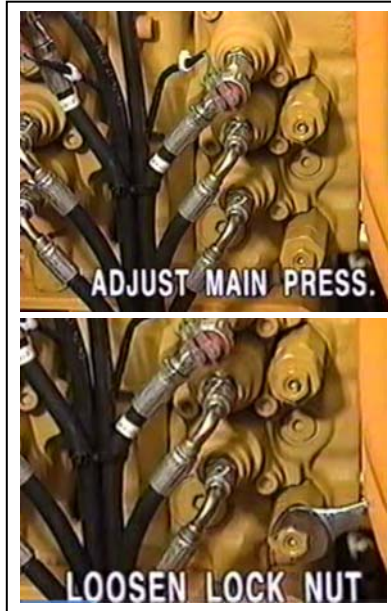
Gambar 4.27 – Mengendurkan mur pengunci
