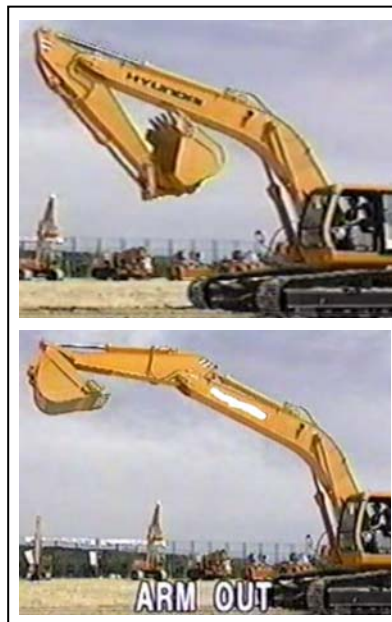
Gambar 4.17 – Pengetesan arm keluar
