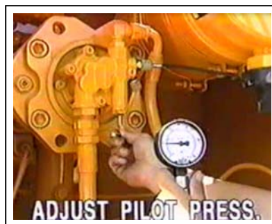
Gambar 4.25– Penyetelan Pilot Pressure
