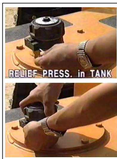
Gambar 4.23 – Membuang tekanan minyak dalam tangki
