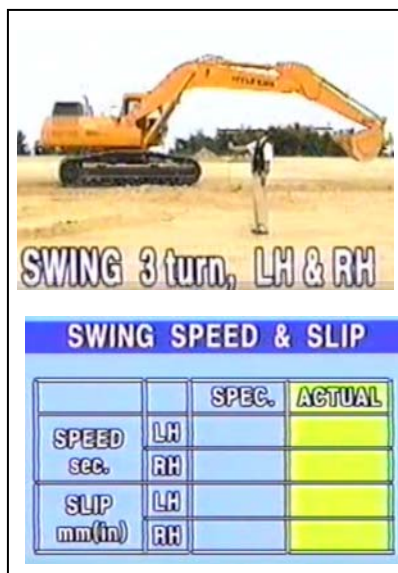
Gambar 4.20 – Pengetesan Swing kanan/kiri
