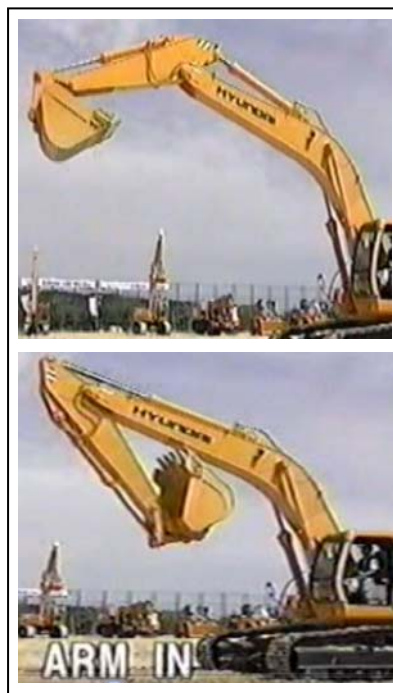
Gambar 4.16 – Pengetesan arm masuk
