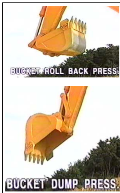
Gambar 4.32 – Penyetelan tekanan minyak silinder bucket
