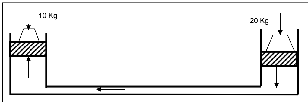
Gambar 4.05 - Cairan akan mengalir dari tempat yang bertekanan tinggi ke tempat yang bertekanan rendah
