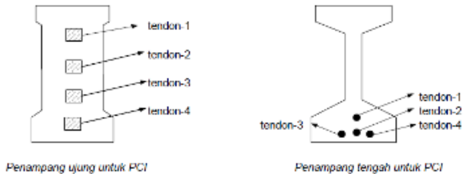
Gambar 2. 5. Letak lubang tendon pada segmental
