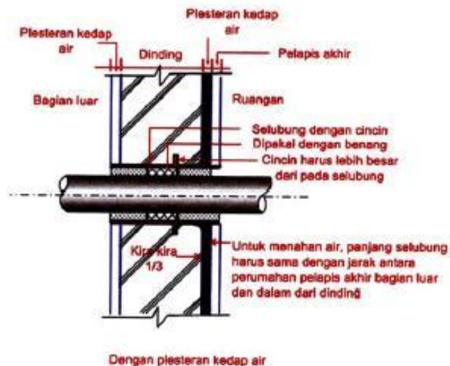
Gambar 4.14 Plesteran Kedap Air Tanpa Penutup Bata
