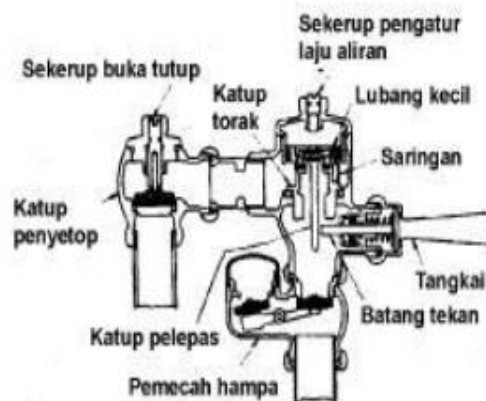
Gambar 11.4 Katup pengglontor jenis torak
