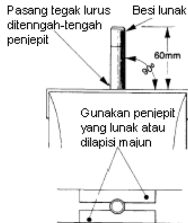
Gambar 5.15 Jepit benda kerja pada ragum
