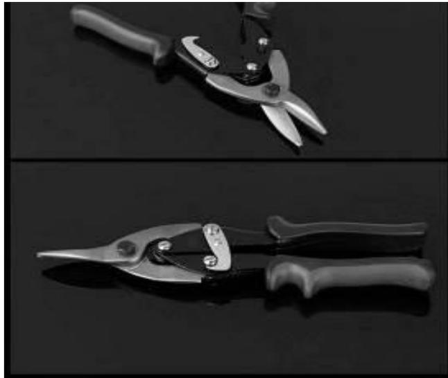
Gambar 3.1 Gunting/pemotong baja ringan
