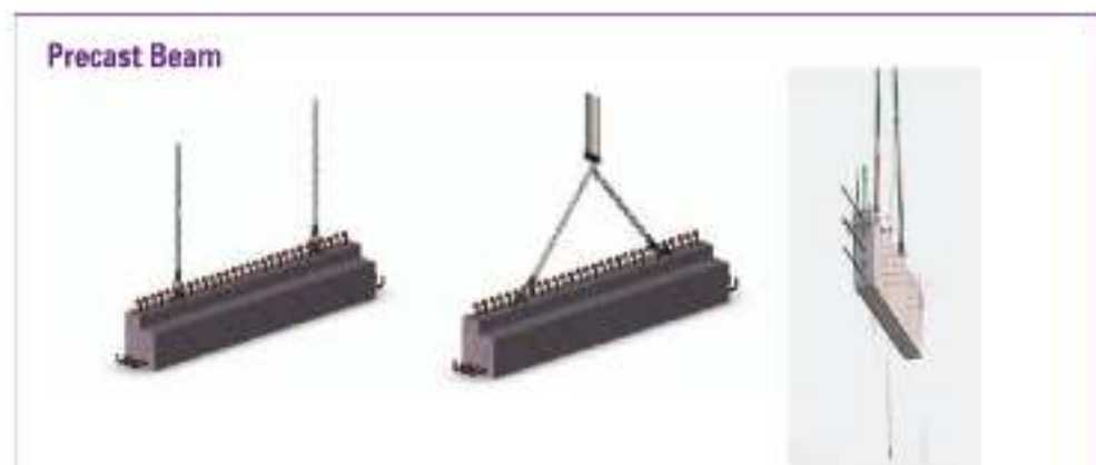
Gambar 4.49 Letak titik angkat pada balok precast
