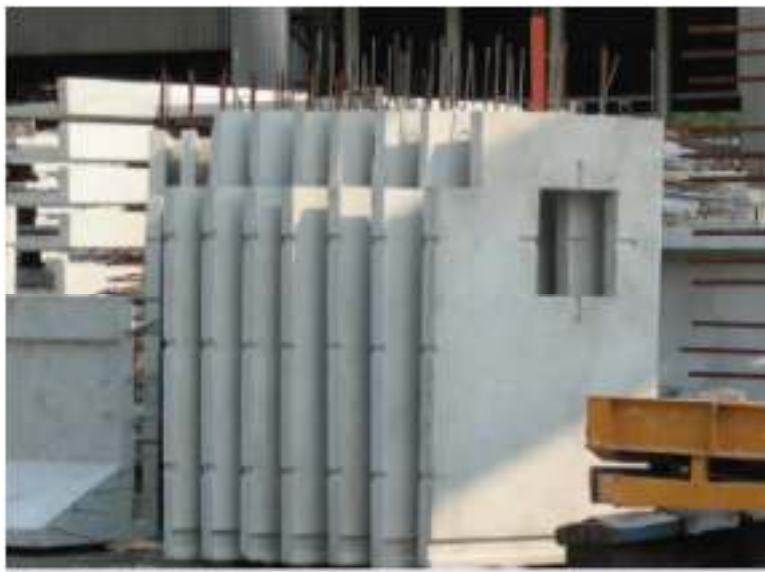
Gambar 4.11 Tempat penyimpanan dengan prinsip "first in first out"
