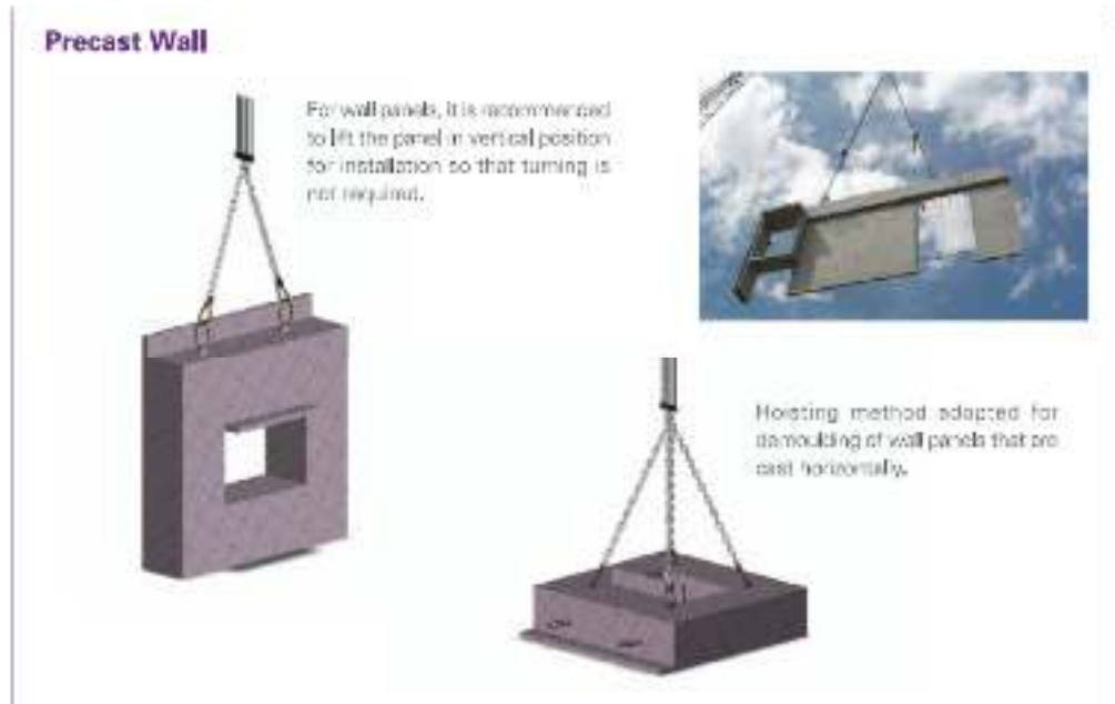
Gambar 4.50 Letak titik angkat pada dinding precast
