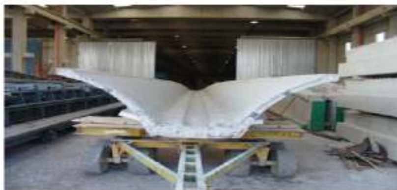
Gambar 4.28 bentuk atap precast yang menyatu dengan talang
