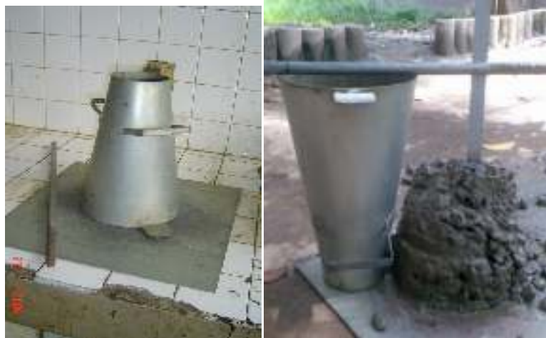
Gambar 4.36 Pengujian slump pada beton segar
