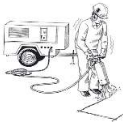
Gambar 4.18 Kompresor dengan kontrol kebisingan – tetap tertutup, menggunakan knalpot pada pneumatik palu dan memakai pelindung pendengaran
