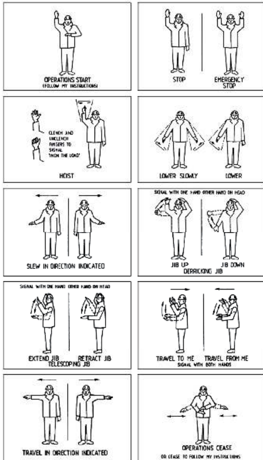
Gambar 4.17 Isyarat yang direkomendasikan pada pekerjaan crane
