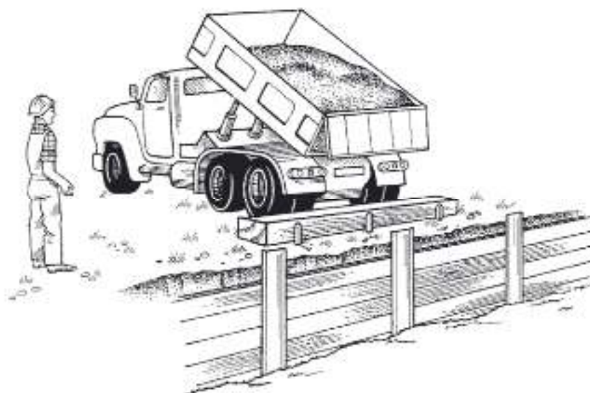
Gambar 4.12 Blok kayu untuk mencegah terperosoknya kendaraan kedalam lubang galian
