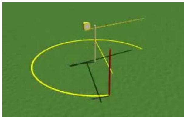
Gbr 4.127 Membuat lingkaran berdasarkan diameter yang ditentukan
