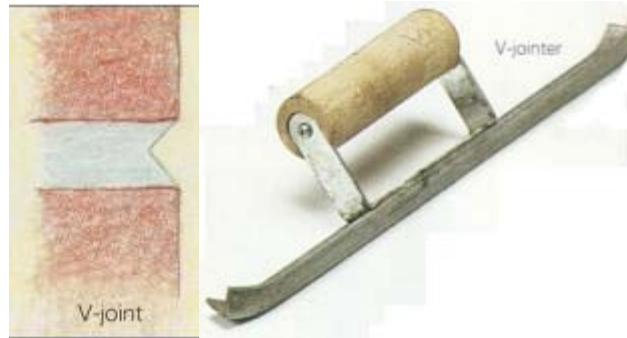
Gbr 4.76 Bentuk nat huruf V dengan jointer yang digunakan
