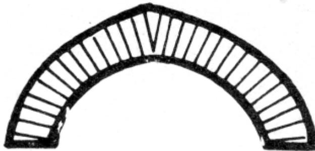
**Gbr. 4.23 Konstruksi pasangan bata lengkung eliptikal gothic**
