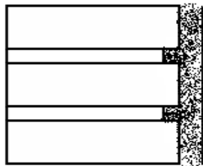
Gbr. 4.17 Adukan ada "pegangan" ( key )
