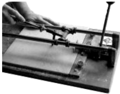
Gbr. 4.18 Memotong ubin dengan alat semi mekanik
