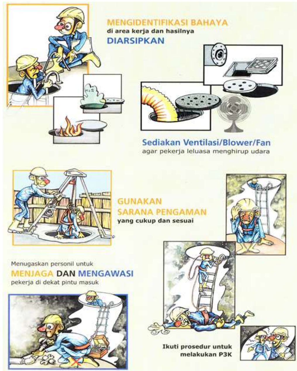
Gambar 3.7 Bekerja di ruang terbatas
