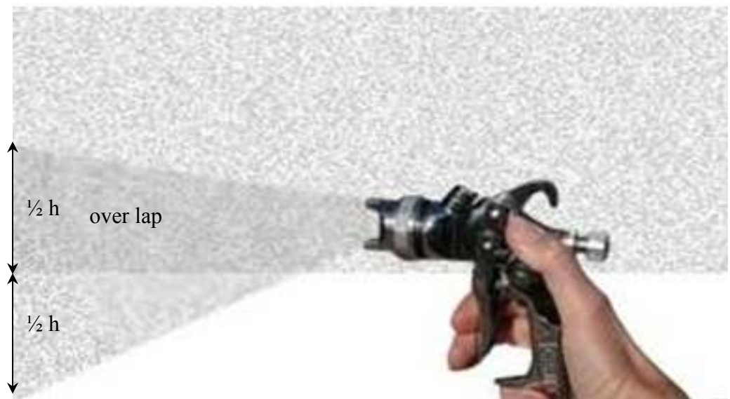
Gb. 30 Menyemprot dengan metode overlapping
