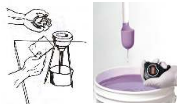
Gb. 33 Mengukur kekentalan dengan viscosity cup
