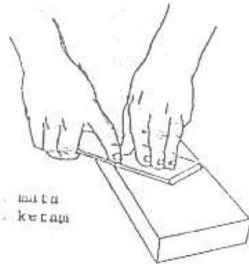
Terakhir adalah menghilangkan bram yaitu dengan mengasah punggung mata ketam seperti yang terlihat pada gambar di sebelah ini.
