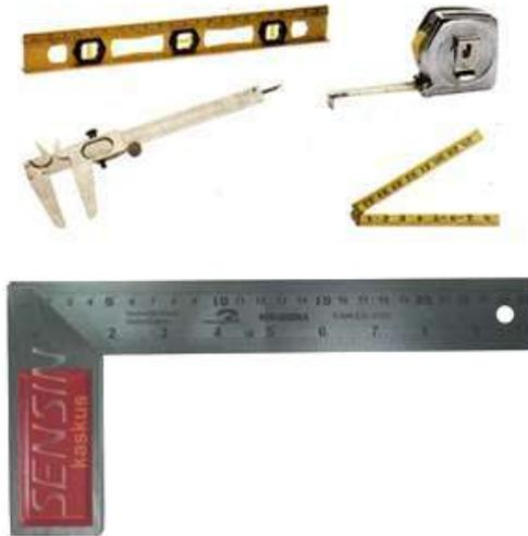
Meteran/roll meter, sebagai alat ukur panjang, lebar dan tebal/tinggi bahan cetakan.
