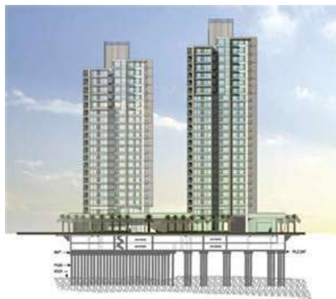
Gambar ilustrasi kerja pondasi (grup) tiang pancang
