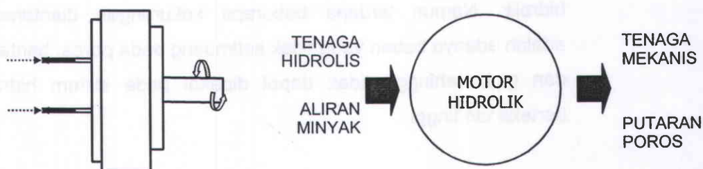
Gambar 50 – Transformasi daya pada Motor Hidrolik
