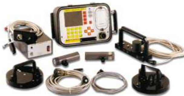
Gambar 4.7. Alat Pendeteksi Korosi Tulangan Beton
